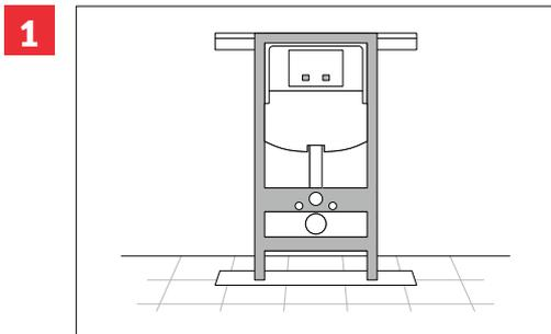
Préparation du support : le coffrage de la structure du bati-support doit être réalisé avant l'installation du Batipanel.
