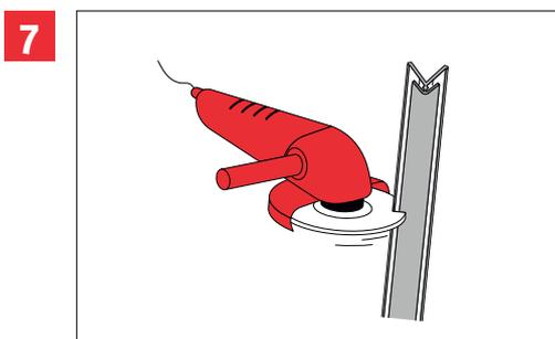
En fonction de la configuration de pose, couper les profilés. Ne pas oublier de prendre en compte la profondeur de la pièce d'angle (15mm).
