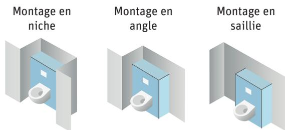
Les dimensions du panneau et la composition du produit permettent de s'adapter à tout type de configuration.
