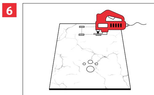
Découper l'emplacement de la plaque de commande avec la scie sauteuse en commençant par les angles à l'aide d'une perceuse. Utiliser la lime pour limer les éventuelles imperfections de découpe.
