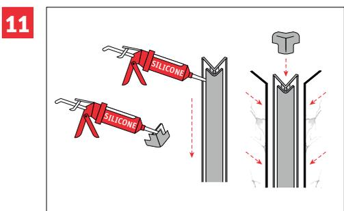
Appliquer un filet de silicone dans la gorge des profilés (sur toute la hauteur) ainsi que dans les pièces d'angle, puis insérer les profilés et les pièces d'angle sur le panneau.
