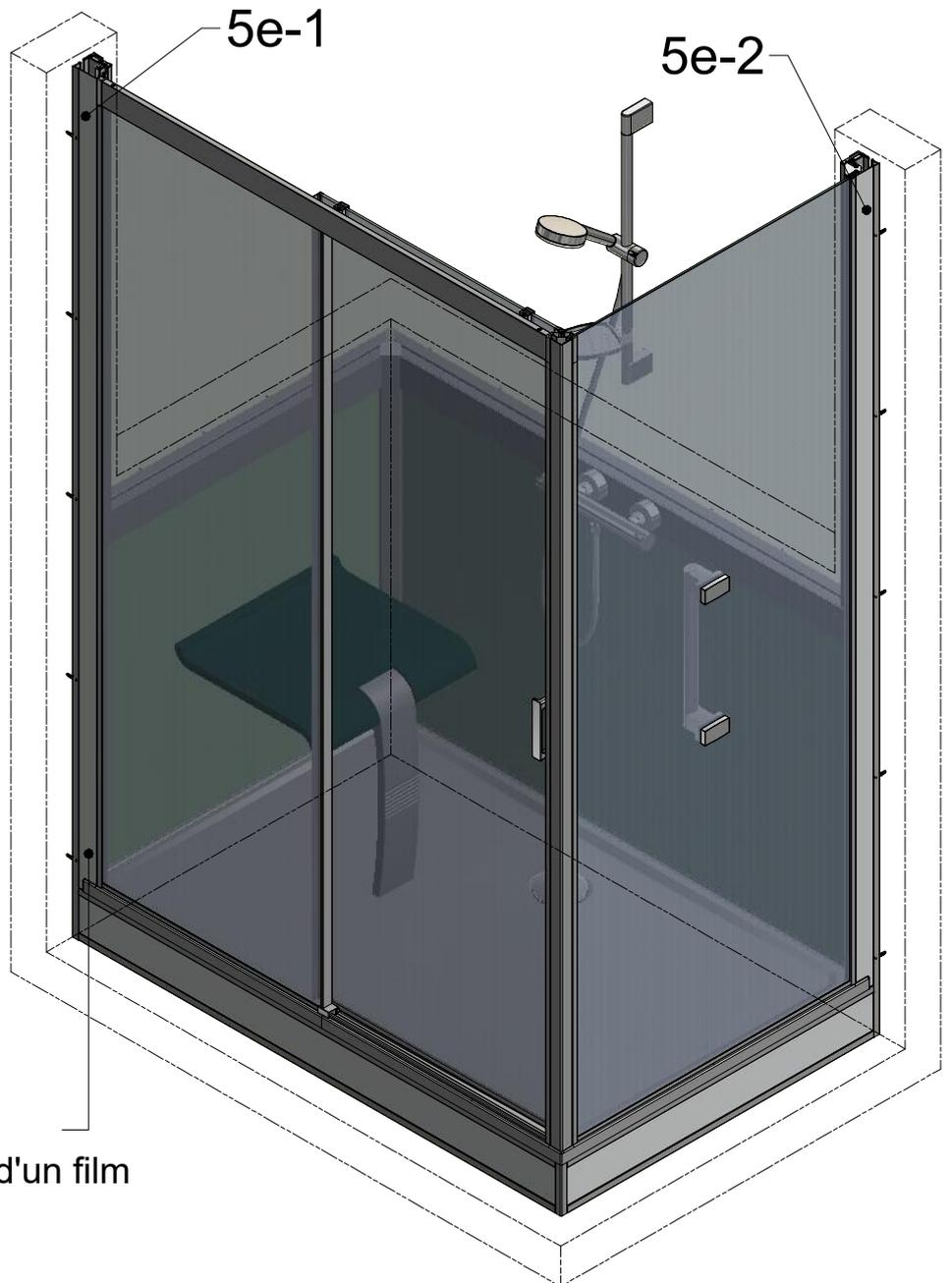
La face avant est recouverte d'un film
