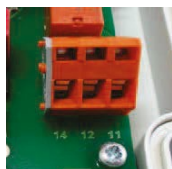
Branchement de la pompe de relevage en aval (en option)
